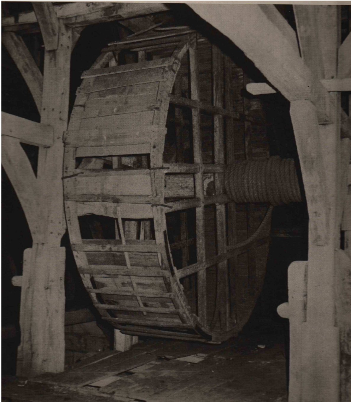
Emelés hengerkerékkel (Beauvais Chatedral) 700 éves gép
